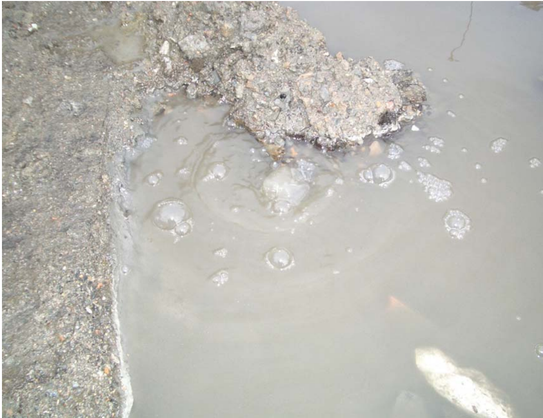
Abb.3 : Gasaustritte auf der Füllsäulenoberfläche
